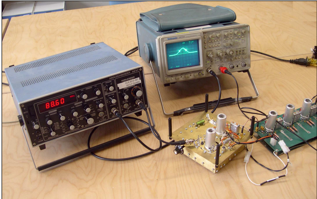
Abgleich der Durchlasskurve mit dem Wobbler
