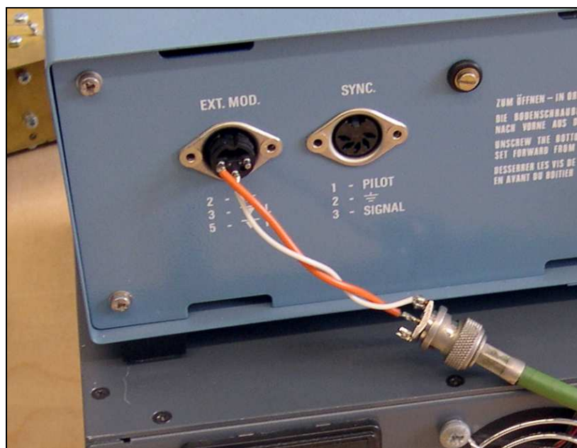
Einspeisung des Modulationssignals
