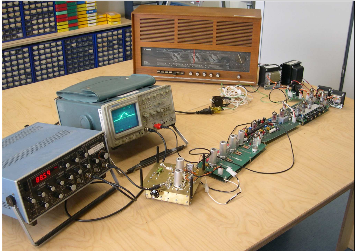
Gesamtaufbau mit ZF-Teil, Stereodecoder, NF-Teil und Netzteil, das SABA-Radio dient als passive Lautsprecherbox.
